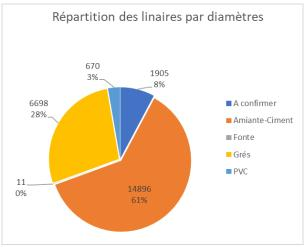
LINEAIRE TOTAL: 24 178 ml de conduite gravitaire et 200 ml de refoulement
